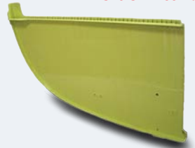
S76 STA 188 Bulkhead
